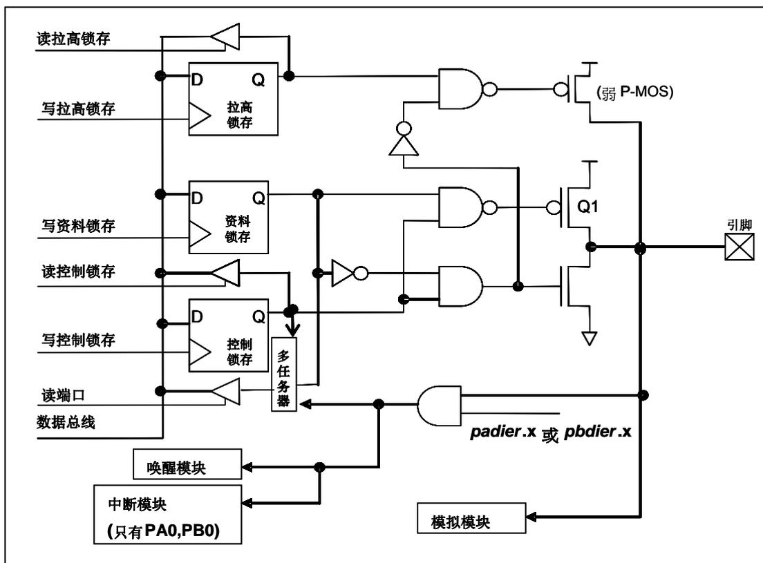
图 9: 引脚缓冲区硬件图
