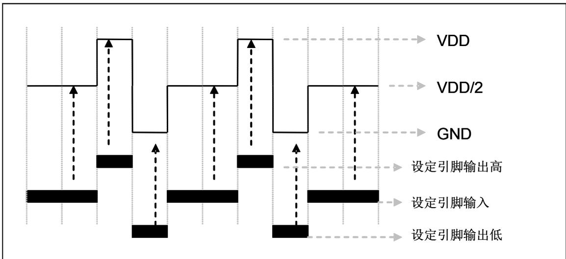
图. 10: 使用 VDD/2 偏置电压
